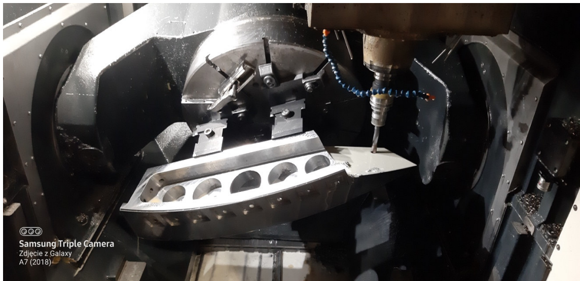
Rys. 13 Podejście oprawy z wiertłem przy chłodzeniu mgłą olejową
