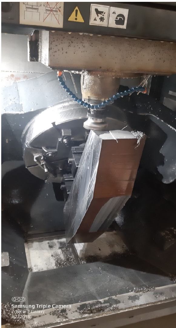
Rys. 17 Obróbka pod kątem w celu sprawdzenia drgań na detalu
