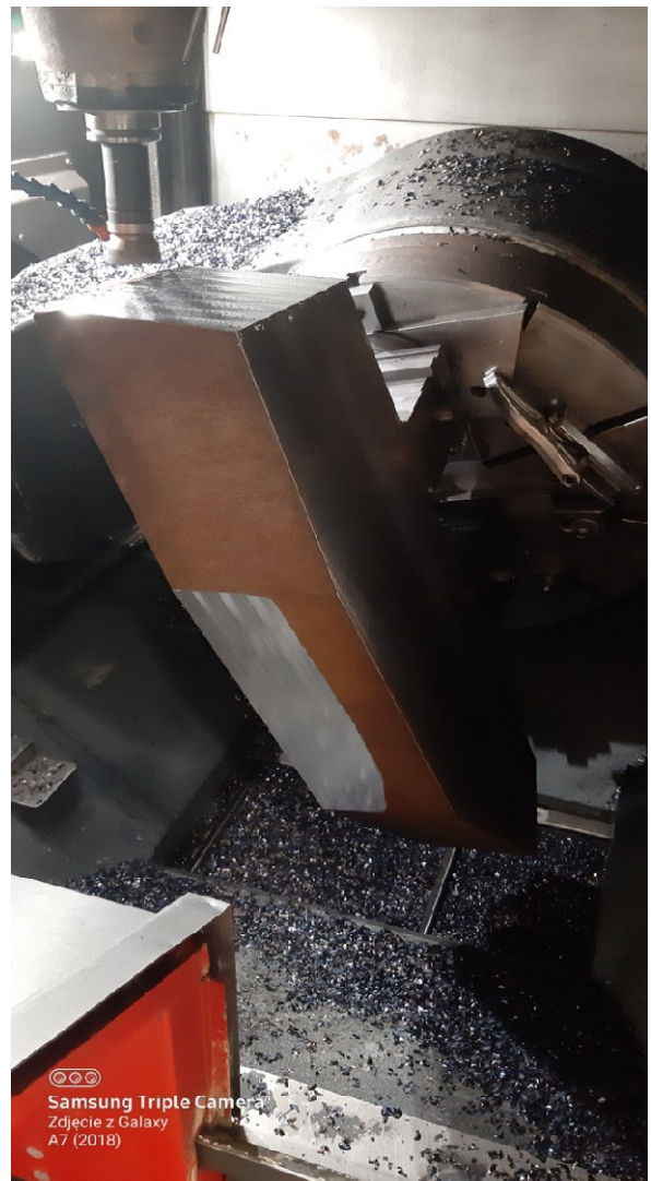
Rys. 17 Obróbka pod kątem w celu sprawdzenia drgań na detalu
