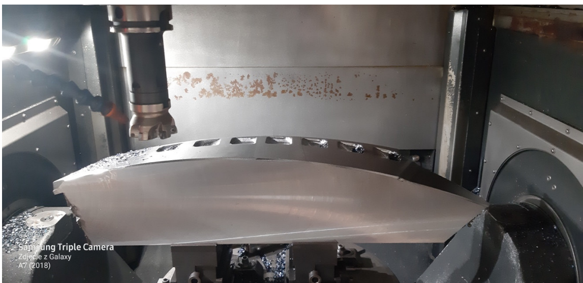
Rys. 12 Podejście głowicy z płytkami WNT_ obróbka gniazda
