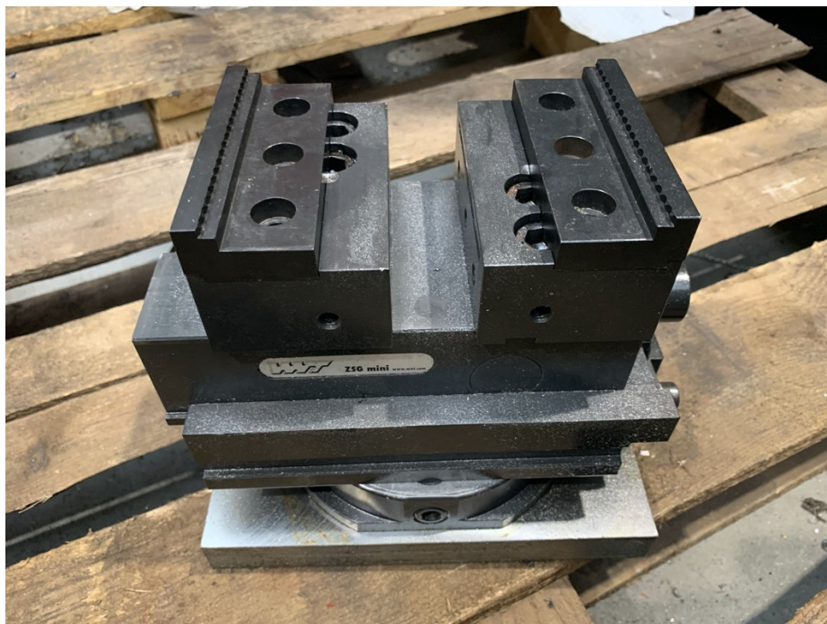
Rys. 8 System mocowania stożka_imadło precyzyjne WNT
