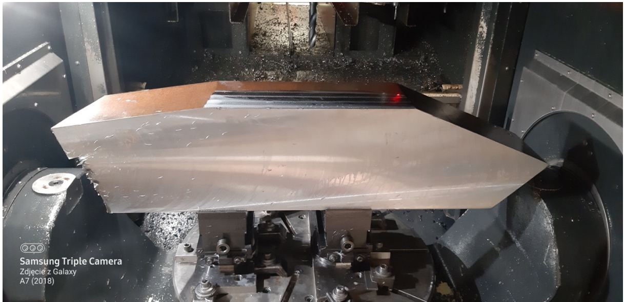
Rys. 18 Zmiana narzędzia i pozycjonowanie wiertła
